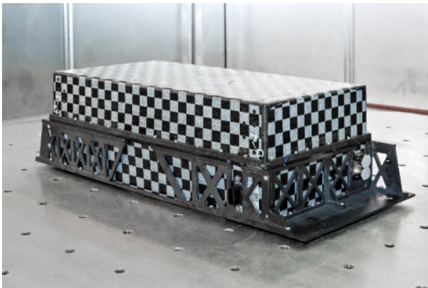
Leicht, nachhaltig, sicher und effizient: Das Batteriegehäuse aus einem Polymerschäumkern und endlosfaserverstärkten Thermoplasten (CFRTP) ist innerhalb von nur zwei Minuten hergestellt und erfüllt zuverlässig seine Funktion. Foto: Fraunhofer LBF, Raapke
