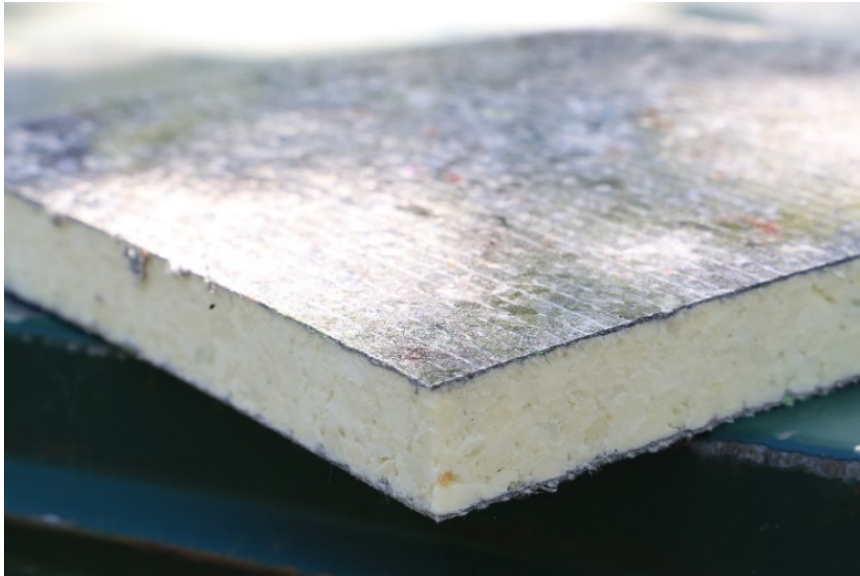
Sandwich-Leichtbauplatte aus Alttextilien und Matratzen-Rezyklat. Foto: Fraunhofer LBF.
